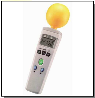
Mesureur de champs électromagnétiques
